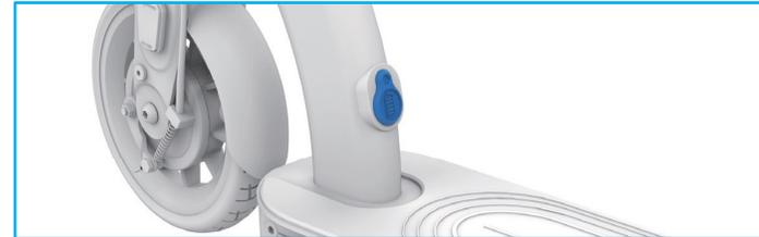
El indicador de nivel de energía de la batería está ubicado sobre el acelerador de pulgar del manillar: Los cinco LEDs encendidos indican que la batería está en su máximo nivel de carga; Si tan solo hay un LED encendido, la batería tiene un bajo nivel de carga.
