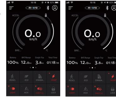
3. Información relacionada con el trayecto, como, por ejemplo: estado de la batería, autonomía, distancia total, duración total, velocidad, temperatura.
