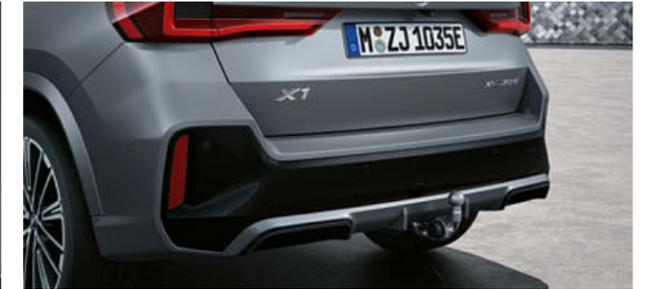
Enganche para remolque con bola giratoria<sup>2</sup> El control de estabilización de remolque y la fijación a prueba de robos aumentan la seguridad.
