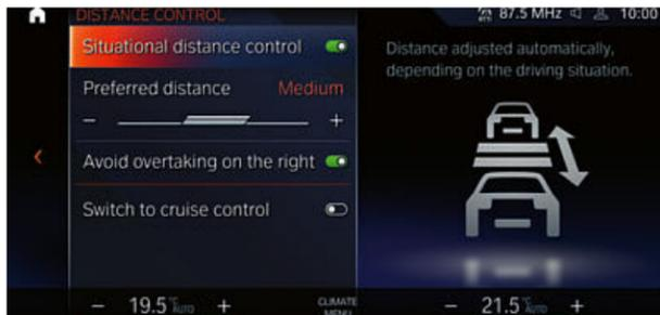
Con el sistema Driving Assistant Plus<sup>1</sup>, viajarás más relajado. Especialmente en los trayectos largos, ayuda al conductor manteniendo automáticamente la velocidad deseada, la trayectoria y la distancia con el vehículo que circula delante y frenando en caso de emergencia. Además, advierte de los límites de velocidad o de la prohibición de adelantar.
