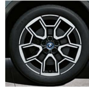
Llantas aerodinámicas de 18 pulgadas estilo 866, en bicolor gris claro con pulido brillante, 7,5 J x 18, neumáticos 225/55 R 18.
