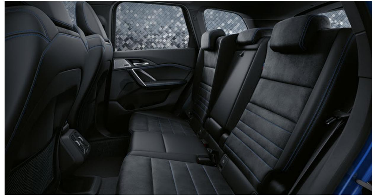
Gracias al reglaje de los asientos traseros, es posible un uso aún más flexible de la parte trasera y del maletero. Las superficies de los asientos pueden deslizarse longitudinalmente 130 milímetros por separado en la proporción 60:40.
