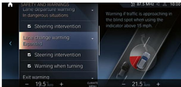
Ya se trate de una colisión frontal inminente o de tráfico transversal detrás, el sistema Driving Assistant avisa y frena automáticamente en caso necesario. Ayuda a evitar accidentes al cambiar de carril o al salir del vehículo. Además, avisa a los vehículos que circulan detrás en caso de riesgo de colisión por alcance inminente. El sistema también puede reducir el riesgo de excesos de velocidad.
