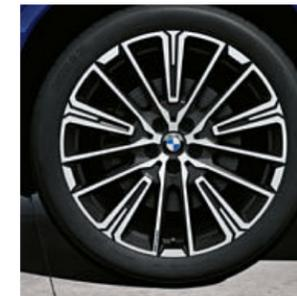
Llantas de aleación ligera BMW Individual de 20 pulgadas con radios múltiples estilo 869 I, en bicolor gris oscuro mate con pulido brillante, 8J x 20, neumáticos 245/40 R 20.
