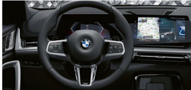
El cambio automático Steptronic de 7 velocidades con levas combina cambios deportivos con una gran eficiencia y el máximo confort de marcha. Las levas de cambio adicionales del volante permiten cambiar de marcha de forma especialmente directa sin tener que retirar las manos del volante. Esto garantiza un manejo óptimo y una gran seguridad.
