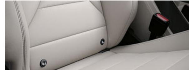
El asiento activo para conductor y acompañante garantiza, con un ajuste lumbar en el respaldo, una correcta postura ergonómica y, con ello, una comodidad óptima. El ajuste lumbar puede regularse eléctricamente en altura y profundidad. Una función de masaje moviliza la parte inferior de la columna vertebral: los asientos contribuyen así a evitar el cansancio.
