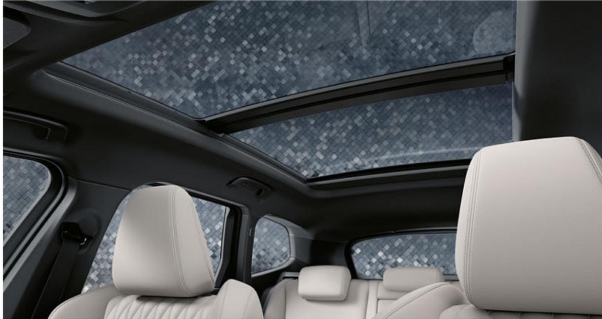
El equipamiento del techo M en color antracita incluye, además del guarnecido interior, el revestimiento de la parte superior de los pilares frontales en acabado de tela en antracita. Este equipamiento se complementa con numerosos elementos en negro: revestimiento de la parte superior de los pilares central y trasero, parasoles, asideros del techo y molduras de los micrófonos.
