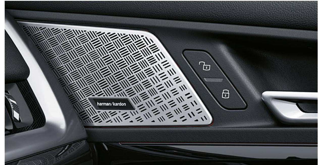
El sistema de sonido HiFi Harman Kardon ofrece, con doce altavoces, una distribución equilibrada del sonido en el BMW. El amplificador de 7 canales garantiza una adaptación especialmente afinada del sonido y, con ello, un sonido brillante. Las molduras de acero inoxidable de los altavoces de agudos con anagrama "Harman Kardon" iluminado entusiasman por su aspecto exclusivo.
