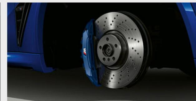
■ Gracias al uso de diferentes materiales, el freno M Compound alcanza, junto a unos valores de deceleración excepcionales, una gran estabilidad, una vida útil larga y una reducción del peso que favorece la agilidad, dinamismo y aceleración. La pinza de freno en azul metalizado con el logo "M" identifica los frenos M de alto rendimiento.
