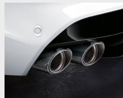
○ Un detalle especial: el revestimiento de fibra de carbono y otros rasgos de diseño confieren a las molduras de los tubos de escape de titanio una apariencia especialmente sólida y poderosa.
