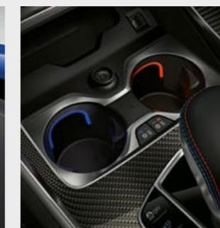
□ Los portabebidas de la consola central pueden, con solo pulsar un botón, enfriar por separado las bebidas que sujetan o mantenerlas calientes.
