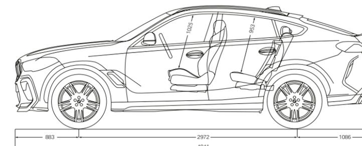
Las dimensiones del dibujo técnico están en milímetros y pueden variar en función del modelo y el equipamiento opcional.
