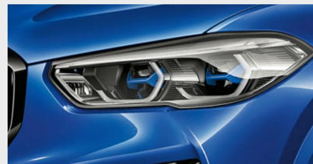
□ La Luz láser BMW con diseño X independiente alumina en el modo de luz de carretera láser hasta 500 m, prácticamente el doble que los faros convencionales. Gracias a la mejor visibilidad en la oscuridad, se incrementa considerablemente la seguridad. El distintivo "X" en azul y el anagrama "BMW Laser" subrayan la aspiración tecnológica del vehículo.
