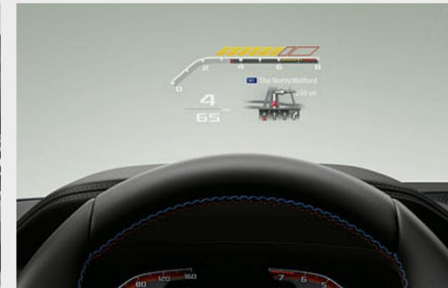
■ El BMW Head-Up Display<sup>3</sup> a todo color, con vista M, proyecta la información relevante en el campo visual del conductor y permite así aumentar la concentración en el tráfico. Se muestran, por ejemplo, la velocidad actual, las indicaciones de navegación, según el equipamiento, el Speed Limit Info con indicador de prohibición de adelantar y las listas de teléfono y reproducción.
