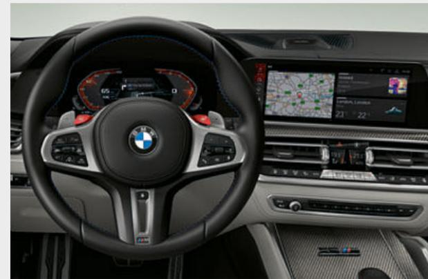
■ BMW Live Cockpit Professional con función de navegación incluye un exclusivo conjunto de visualización: un display de control de alta resolución de 31,24 cm (12,3 pulgadas) con función táctil y un cuadro de instrumentos totalmente digital de 31,24 cm (12,3 pulgadas). BMW Operating System 7 se puede manejar, por ejemplo, con el controlador iDrive Touch.
