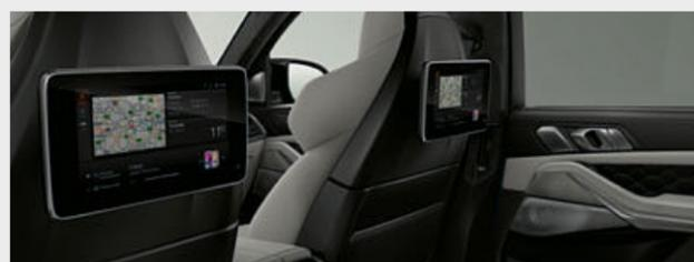
□ El equipamiento del sistema de entretenimiento en la parte trasera Professional incluye dos pantallas en color de alta resolución e independientes de 26,04 cm (10,2 pulgadas) con inclinación regulable, funcionamiento táctil y una unidad de Blu-ray. Esto permite la navegación y el uso de Internet en marcha (con un contrato de telefonía móvil). Además, se ofrecen una conexión USB y conexiones para reproductor MP3, consolas de videojuegos y auriculares (también inalámbricos).
