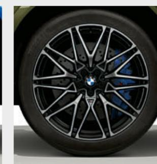
□ Llantas de aleación ligera M de 21/22 pulgadas con radios en estrella estilo 818 M, en bicolor Schwarz, con neumáticos de distintas medidas, pulido brillante, delante 10,5 J x 21, neumáticos 295/35 R 21, detrás 11,5 J x 22, neumáticos 315/30 R 22.<sup>1</sup>
