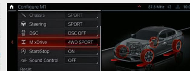
■ Con el sistema BMW M xDrive con diferencial M activo, se garantiza la máxima tracción y dinamismo de conducción tanto en la vida diaria como en el circuito. La tecnología M combina la agilidad de la tracción trasera con el dominio de la tracción integral a las cuatro ruedas. Así es posible elegir entre las variantes de tracción 4WD, 4WD Sport y, en el modo DSC-off, 2WD.
