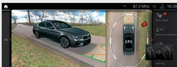
□ El Parking Assistant Plus facilita el estacionamiento y las maniobras del vehículo. Incluye, por ejemplo, el sistema Surround View, con Top View, Panorama View y Remote 3D View, así como ayuda de aparcamiento lateral<sup>4</sup>, Control de Distancia de Aparcamiento Activo con función de frenado de emergencia, asistente de estacionamiento con guiado longitudinal y transversal y asistente de marcha atrás.
