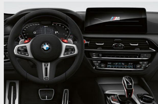
■ BMW Live Cockpit Professional con función de navegación incluye un exclusivo conjunto de pantallas: un display de control de alta resolución de 31,24 cm (12,3 pulgadas) con función táctil y un cuadro de instrumentos totalmente digital de 31,24 cm (12,3 pulgadas). BMW Operating System 7 se puede manejar, por ejemplo, con el controlador iDrive Touch.
