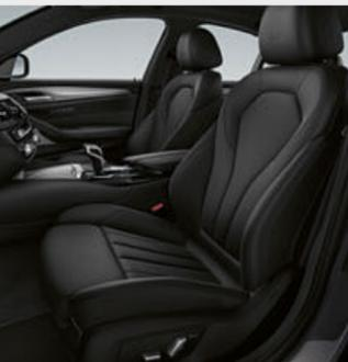
■ Los asientos deportivos para conductor y acompañante ofrecen una sujeción óptima gracias al ajuste de profundidad del asiento, de los laterales del respaldo y de la inclinación del asiento y del respaldo, así como del desplazamiento longitudinal.
