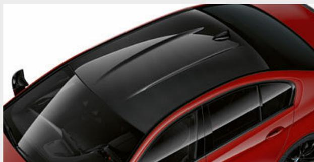
■ Como parte del concepto de construcción ligera inteligente, el techo M de fibra de carbono contribuye a la reducción de peso del vehículo. Está hecho de carbono (PRFC) y es 800 g más ligero que el techo de aluminio de serie. Así, el centro de gravedad del vehículo se desplaza hacia abajo y aumenta el dinamismo.
