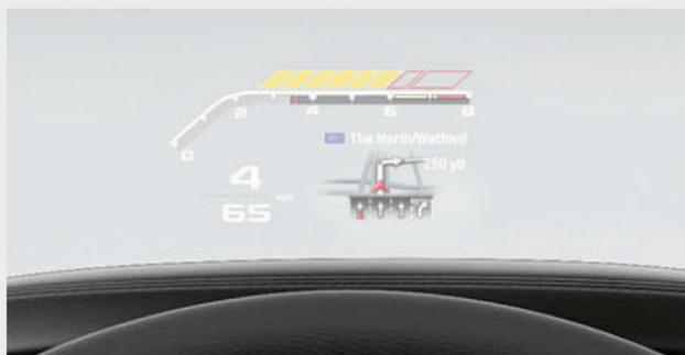
■ El BMW Head-Up Display<sup>2</sup> a todo color con indicaciones M proyecta la información relevante para la conducción directamente en el campo visual del conductor. Las indicaciones M se cambian pulsando un botón y presentan la marcha, el régimen en forma de banda dinámica, Shift Lights para indicar el momento óptimo de cambio de marcha y las instrucciones de navegación.
