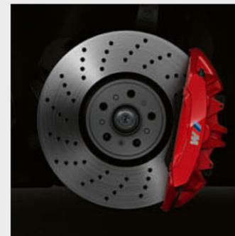
□ Los frenos con componentes M en rojo brillo exhiben pinzas de freno en rojo de brillo intenso y ofrecen, gracias a una combinación especial de materiales, unos valores de deceleración excepcionales y una larga vida útil.
