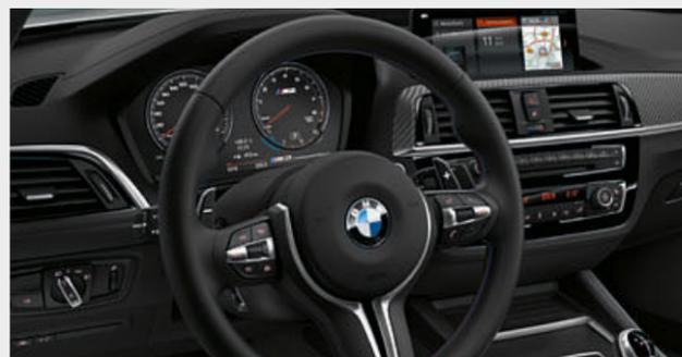
■ El volante multifunción permite, dependiendo del equipamiento, controlar las funciones de teléfono, voz y audio utilizando los botones del volante. Además, se integra el limitador de velocidad manual con el que, por ejemplo, puede establecerse el límite de velocidad en zonas urbanas en 50 km/h.
