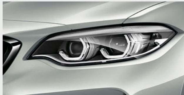
■ Los faros LED autoadaptables, con luces de cruce y de carretera, incluyen, por ejemplo, luces autoadaptables y un asistente de luz de carretera.
