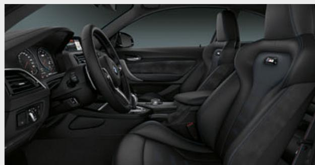
□ Los asientos deportivos M de varios ajustes, diseño envolvente y reposacabezas integrados ofrecen al conductor y al acompañante una excelente sujeción lateral. Además, es posible ajustar individualmente la anchura del respaldo. El estilo específico con el logotipo "M2" iluminado pone aún más en evidencia la ambición deportiva del vehículo.
