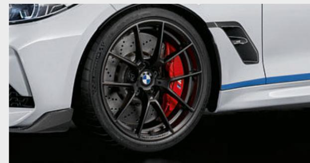
○ Llantas forjadas M Performance de 19 pulgadas de peso optimizado con radios en Y estilo 763 M en Jet Black mate. Juego completo de ruedas de verano RDC con neumáticos de distintas medidas.
