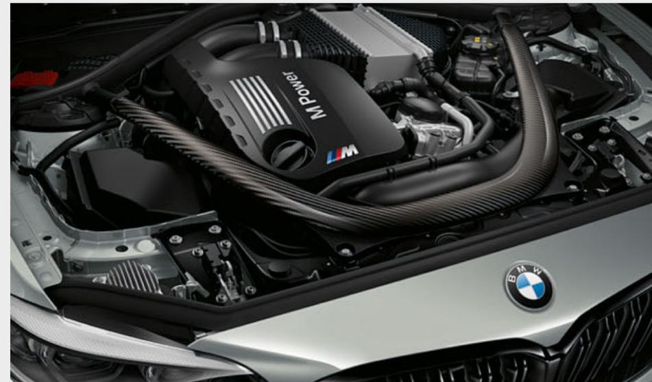
■ El puntal de precisión de plástico reforzado con fibra de carbono es una importante pieza de la carrocería, procedente del mundo de la competición, que se encuentra en el compartimento del motor. Este incrementa, con sólo 1,5 kg de peso, la rigidez de la parte delantera del vehículo y mejora la precisión de la dirección y la estabilidad del vehículo.
