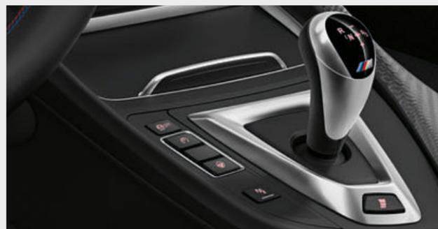
□ Cambiar sin interrumpir la tracción, sin accionar el embrague, sin dejar de acelerar: el cambio de doble embrague M de 7 velocidades con Drivelogic. El cambio de marcha se lleva a cabo de forma automática o manualmente mediante las levas de cambio del volante o la palanca de cambio. El sistema Launch Control garantiza una aceleración óptima desde parado.
