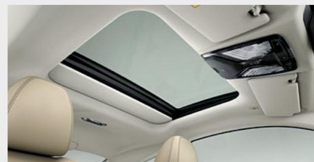
□ El techo de cristal corrediza y abatible, con cortinilla interior corrediza eléctricamente, dispositivo de protección antiaprisionamiento y apertura y cierre de confort, permite la regulación individual del flujo del aire y, con ello, un clima agradable en el interior. El deflector integrado evita las corrientes de aire en el interior y garantiza un nivel de ruido reducido.
