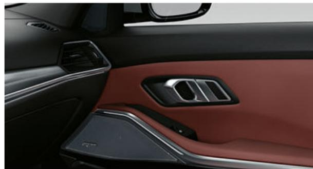
Con sus 16 altavoces, amplificador digital de 464 vatios y nueve canales, el sistema de sonido envolvente Harman Kardon te permitirá disfrutar de una experiencia sonora armoniosa y envolvente. El sistema reproduce voces e instrumentos con gran fidelidad. La ecualización, totalmente automática y en función de la velocidad, compensa los ruidos propios de la conducción.
