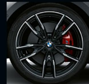
Llantas de aleación ligera M de 19" con radios dobles estilo 792 M, en bicolor Jetblack, con neumáticos de distintas medidas Run-Flat, pulido brillante, delante 8 J x 19, neumáticos 225/40 R 19, detrás 8,5 J x 19, neumáticos 255/35 R 19.<sup>1</sup>
