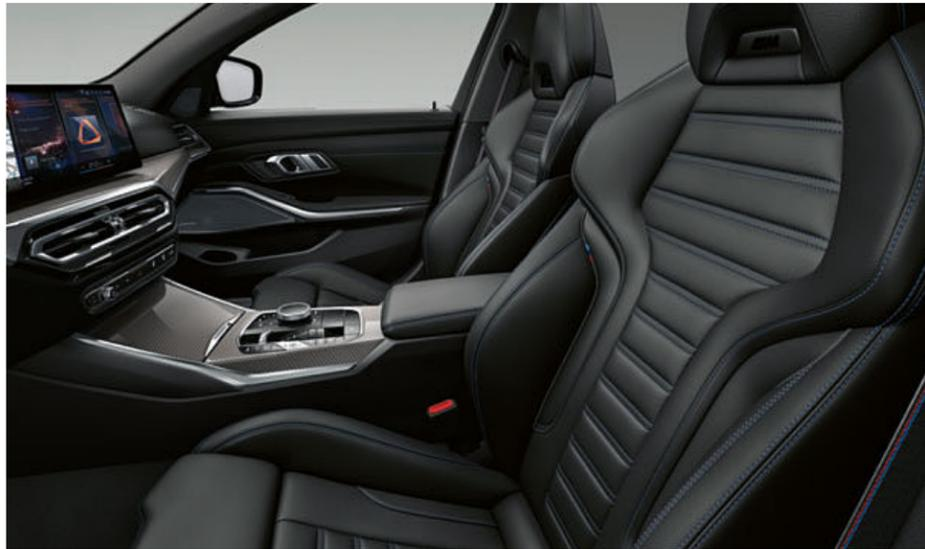
Los asientos M Sport delanteros<sup>1</sup> de varios ajustes con carácter envolvente y reposacabezas parcialmente integrados ofrecen una sujeción óptima en las curvas.
