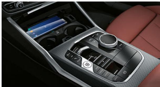
La bandeja para carga inalámbrica cargará tu smartphone cómodamente sin cable con una potencia de hasta 15W. La refrigeración integrada evita el sobrecalentamiento.
