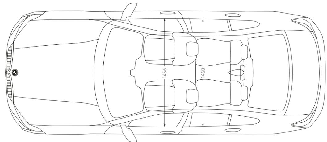
Las dimensiones del dibujo técnico están en milímetros y pueden variar en función del modelo y el equipamiento opcional.
