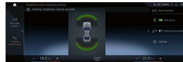
El sistema Parking Assistant<sup>1</sup> facilita las maniobras de estacionamiento del vehículo. La cámara para marcha atrás y el asistente de marcha atrás ayudan en la marcha atrás. El Control de Distancia de Aparcamiento Activo incrementa la protección frente a posibles daños durante el aparcamiento. El asistente de estacionamiento aparca el vehículo de forma automática en paralelo a la calzada y en batería, y también lo saca de las plazas de aparcamiento en paralelo.
