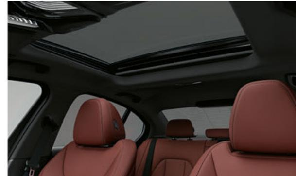
El techo de cristal eléctrico, que es corredizo y abatible, hace posible un flujo de aire regulable individualmente, sin corrientes de aire y con el mínimo ruido del viento.
