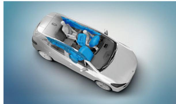
■ Los airbags frontales para conductor y acompañante, los airbags laterales integrados en los refuerzos de los respaldos de los asientos delanteros y los airbags de cabeza integrados en los pilares delanteros y el larguero del techo para los cuatro plazas exteriores figuran entre los componentes de seguridad óptimamente coordinados de un BMW y ofrecen una protección selectiva en caso de accidente.
