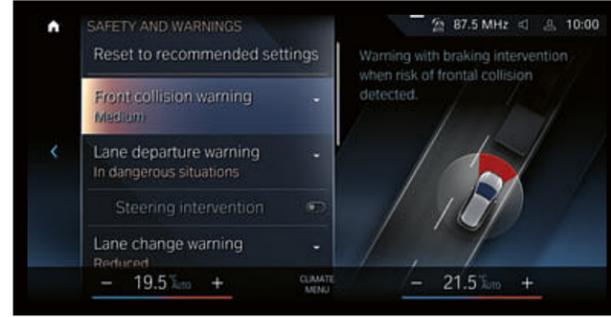
□ El sistema Driving Assistant Plus<sup>3</sup> incluye sistemas de asistencia al conductor basados en cámara y radar, como el control de distancia (ACC con Stop&Go) y el control de trayecto. El paquete incluye también el Speed Limit Assist automático y el Speed Limit Info con indicación de prohibición de adelantar y previsión.
