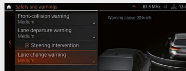
□ El paquete de seguridad Driving Assistant<sup>3</sup>\* ofrece los siguientes sistemas: aviso de colisión frontal con función de frenado, Speed Limit Assist, que incluye Speed Limit Info con indicación de prohibición de adelantar y previsión, y aviso de salida de trayecto. Además, los equipamientos basados en radar cuentan con aviso de tráfico trasero, advertencia de cambio de carril y aviso de colisión por alcance.
