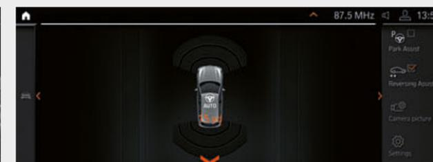
□ El Reversing Assistant\* registra, cuando se circula hacia adelante a velocidades de hasta 35 km/h, los últimos 50 metros del camino para poder volver a recorrerlo en sentido contrario si se desea. Así se libera al conductor del control de la dirección para que pueda concentrarse en el entorno del vehículo.
