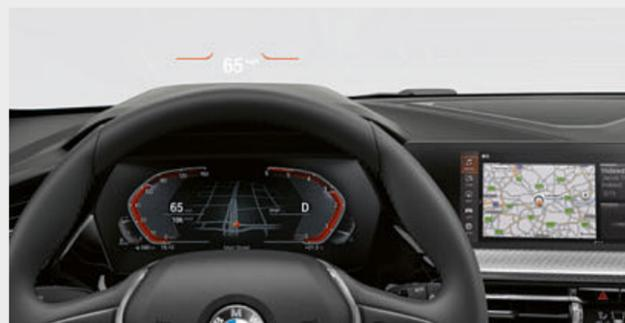
■ BMW Live Cockpit Professional\* con función de navegación incluye un exclusivo conjunto de indicadores que consta de un display de control de alta resolución de 26,04 cm (10,25 pulgadas) con función táctil y un cuadro de instrumentos totalmente digital de 26,04 cm (10,25 pulgadas). BMW Operating System 7 se puede manejar, por ejemplo, con el controlador iDrive Touch.
