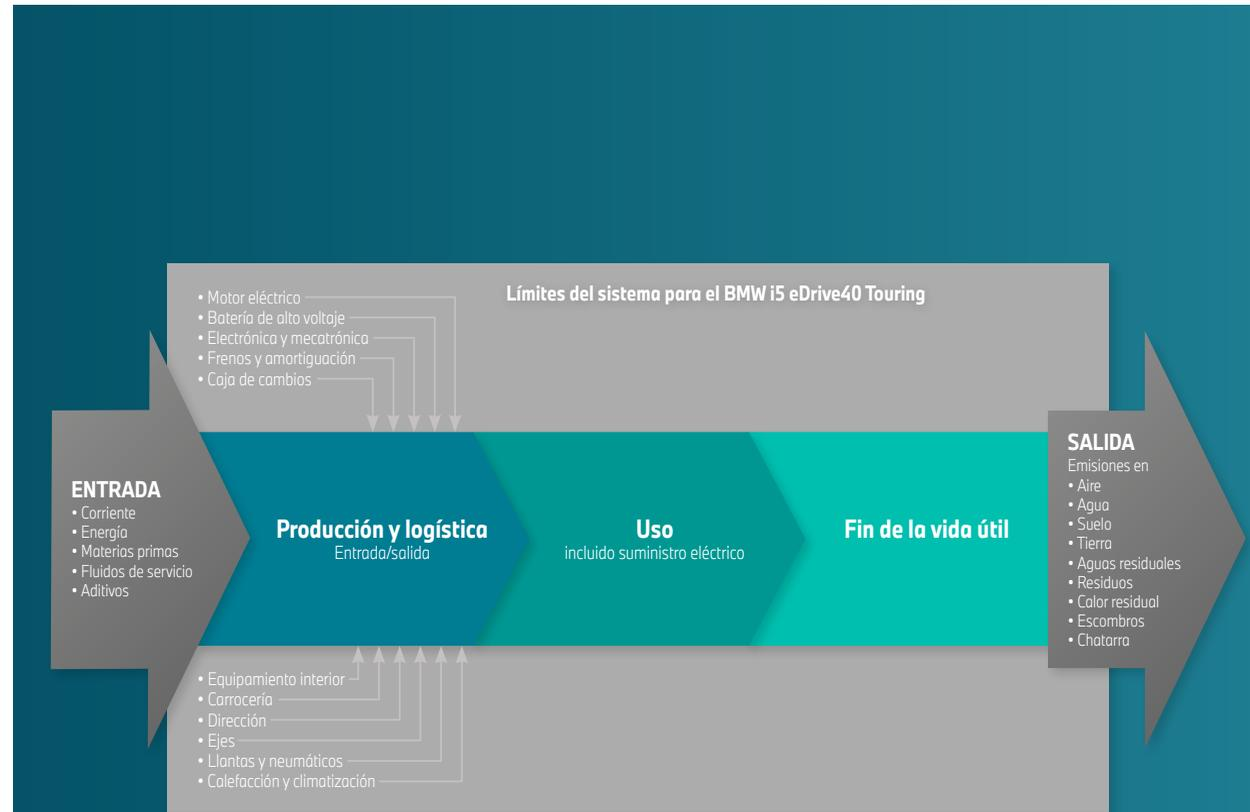
Fig. 1: Límite del sistema del análisis del ciclo de vida del BMW i5 eDrive40 Touring
