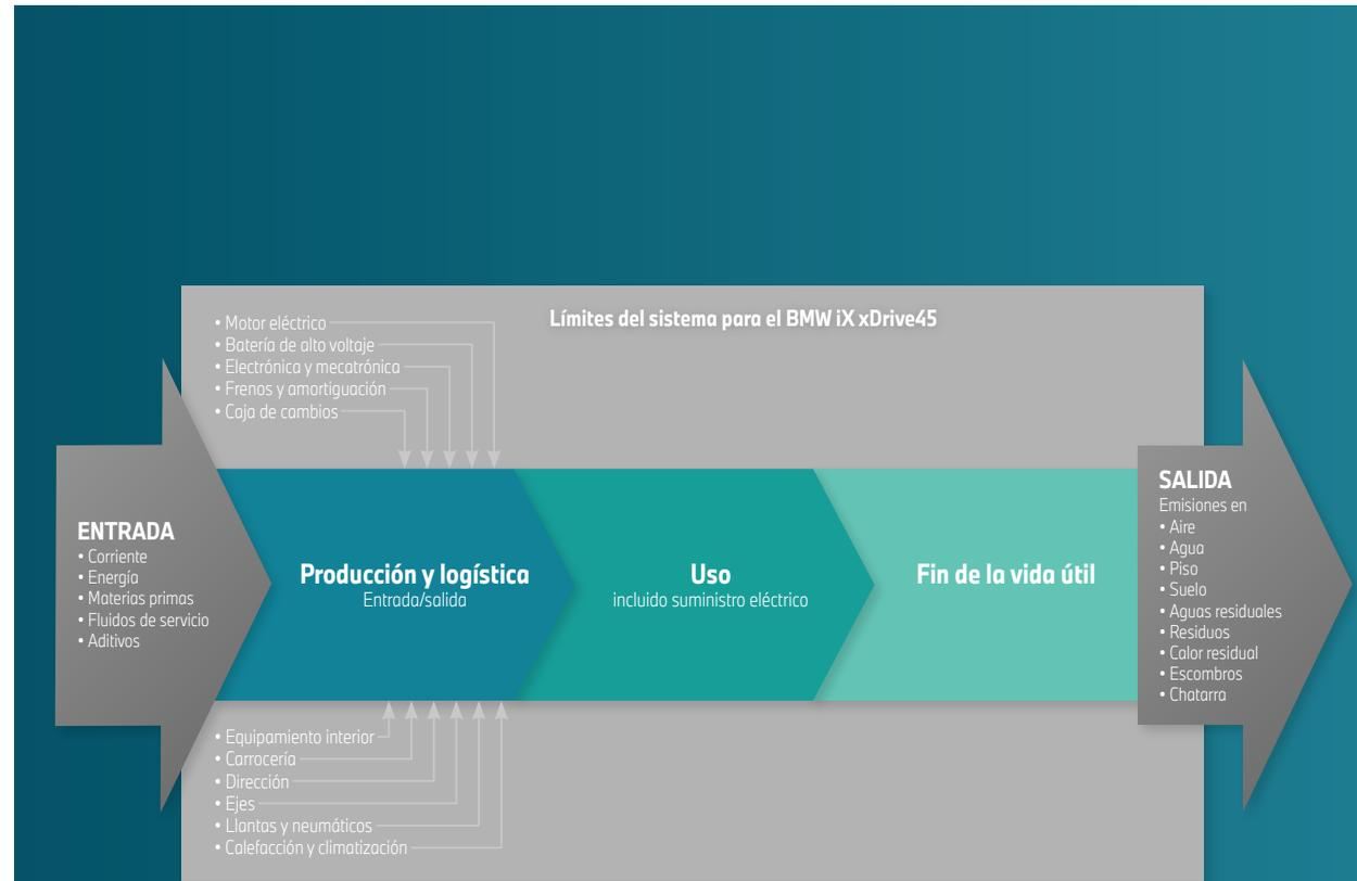
Fig. 1: Límites del sistema para el ACV del BMW iX xDrive45
